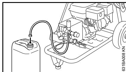
Cu ajutorul furtunului de aspirație se poate aspira și mixa detergent dintr-un recipient separat:
