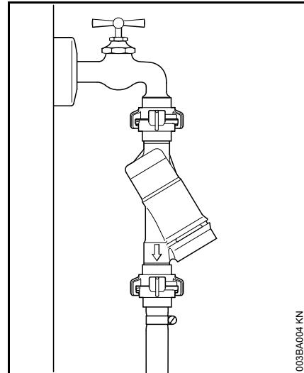
Vesihanjan ja letkun väliin on asennettava paluuvirtauksen estin, jos liität laitteen vesijohtoverkkoon. Paluuvirtauksen estimen tulee olla maakohtaisten määräysten mukainen.
