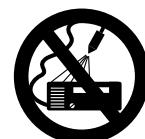
Nu străpîniți cu jetul de înaltă presiune sau cu furtunul cu apă electroulajele – **pericol de scurtcircuitare!**
