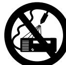
Ни в коем случае не направлять высоконапорную струю или водяной шланг на электрооборудование – **опасность короткого замыкания!**
