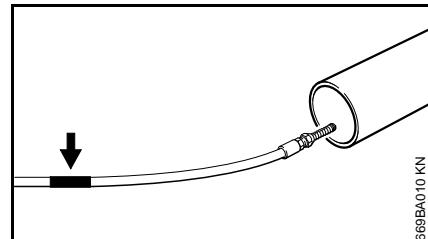
Un marquage (flèche) se trouve à l'extrémité du tuyau de nettoyage :
