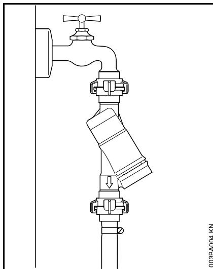
Pour le raccordement au réseau d'eau potable, il faut intercaler un clapet de non-retour entre le robinet d'eau et le flexible. Le type du clapet de non-retour doit satisfaire aux prescriptions nationales spécifiques.
