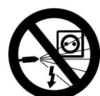
Nu străpîniți cu jetul de înaltă presiune sau cu furtunul cu apă aparatele electrice, raccordurile și cablurile străbătute de curent – **pericol de scurtcircuitare!**
