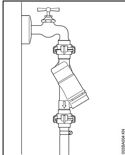
Vid anslutning till dricksvattennätet ska en backventil installeras mellan vattenkranen och slangen. Konstruktionen på backventilen måste motsvara de föreskrifter som gäller i respektive land.
